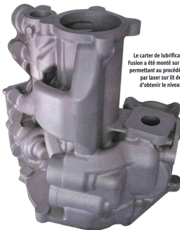
Le carter de lubrification réalisé par AGS Fusion a été monté sur un moteur Leap-1A, permettant au procédé de fusion sélective par laser sur lit de poudre aluminium d'obtenir le niveau de maturité TRL 6.
